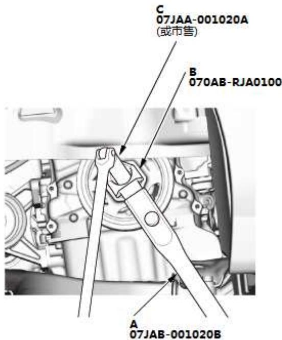
1. 用固定器手柄 (A) 和曲轴皮带轮固定架 (B) 固定曲轴皮带轮。
