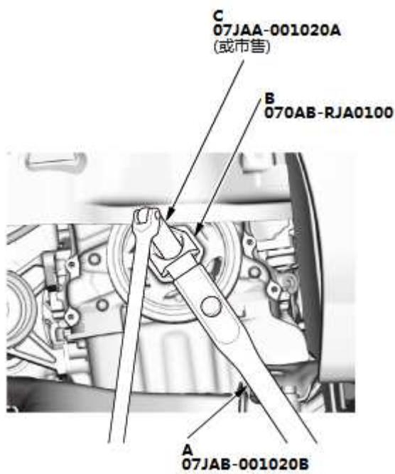
2. 安装曲轴皮带轮，并用固定器手柄 (A) 和曲轴皮带轮固定器 (B) 固定皮带轮。
