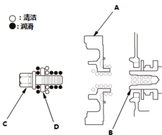
1. 清除所有机油并清理曲轴皮带轮 (A)、曲轴 (B)、螺栓 (C) 和垫圈 (D)。如图所示，用新的发动机机油润滑。
